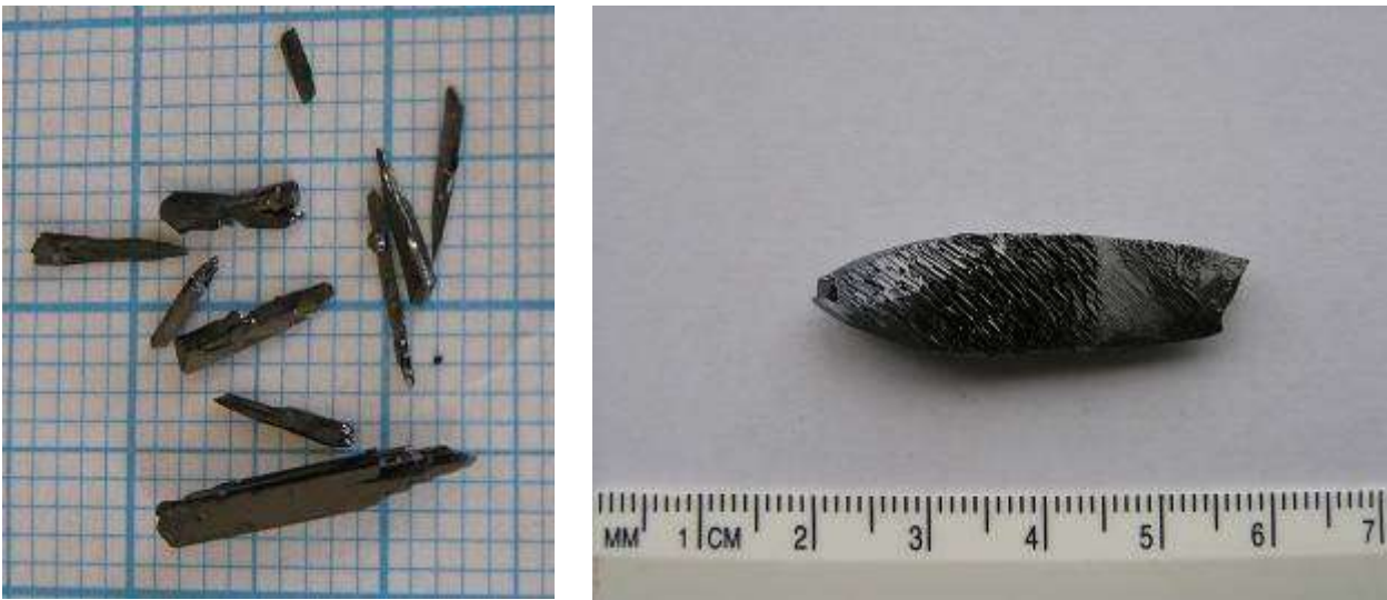
Рис. 11. Кристали Cu_2CdSiS_4 (зліва) та Cu_2CdInSe_2Te_2 (зправа) одержані відповідно методами хімічних транспортних реакцій та горизонтальним варіантом методу Бріджмена-Стокбаргера.
