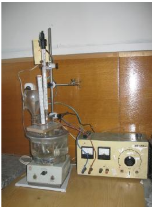
Рис. 1. Прилад для електрохімічного синтезу НП кадмій сульфідів
