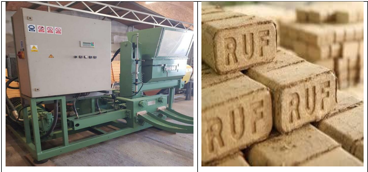
Рис. 3.3. Брикетувальний прес RUF 440 та брикет паливний
