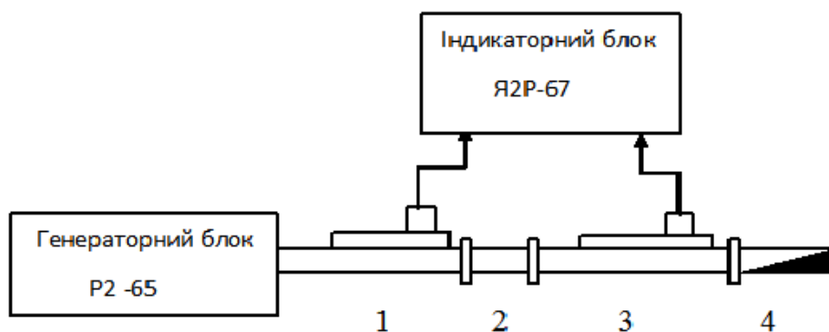
Рисунок 2 – Блок-схема експериментальної установки для визначення коефіцієнту передачі (1, 3 – напрямлені відгалужувачі, 2 – хвилевід із зразком, 4 – узгоджене навантаження)
