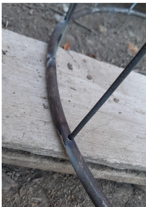
Рисунок 2.11. Кріплення каркасних дротів до круглої основи
