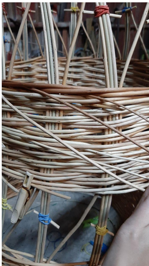
Рисунок 2.16. Пошарове плетиво в два пруті
