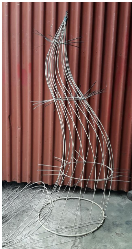
Рисунок 2.12. Формування каркасу та кріплення його до внутрішніх допоміжних кілець
