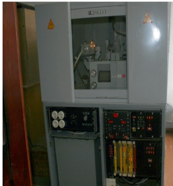
Дифрактометр ДРОН 4-13 в рентгенівській лабораторії факультету хімії та екології
