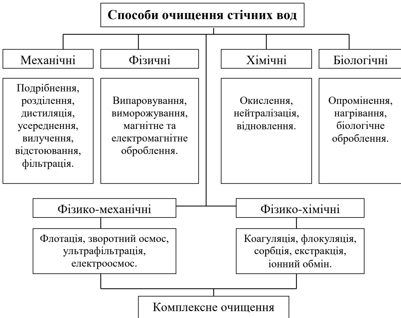
Рис. 1. Способи очищення виробничих стічних вод
