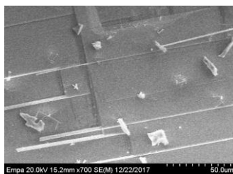
Рис. 4.5. Фотографії поверхні сплаву Tl_2Ga_2GeSe_6 перпендикулярно (ліва) та паралельно (права) площини спайності [4]
