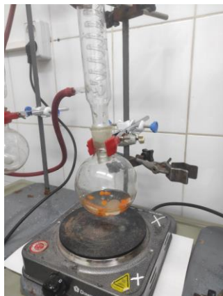
Рисунок 3.7. Екстрагування олії в апараті Сокслета
