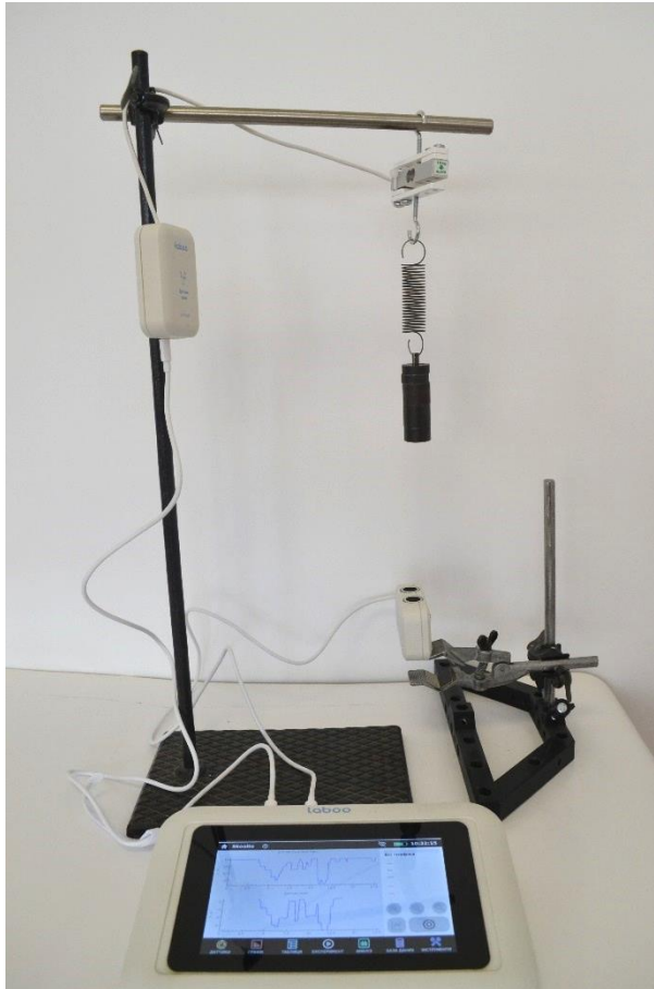
Рис. 2.3. Установка для визначення жорсткості пружини
