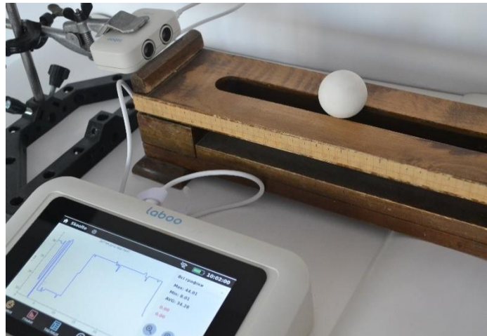
Рис. 2.1. Експериментальна установка для демонстрації залежності координати тіла від часу при нерівномірному русі.
