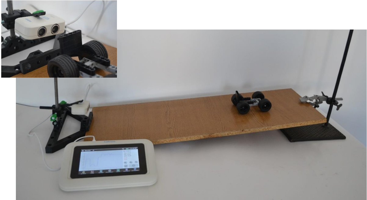
Рис.2.2. Експериментальна установка для дослідження характеристик руху тіла, яке рухається по похилій площині
