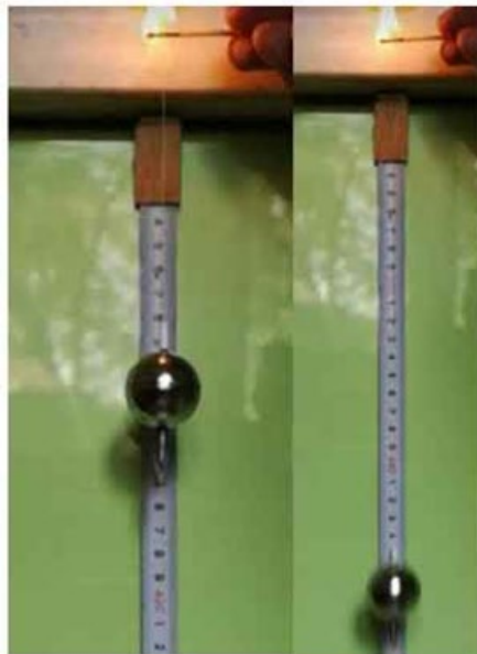
Рис. 3.15 Кадри уповільненого відео вільно падаючої металевої кулі
