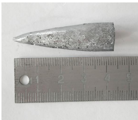
Рис. 5.1. Фото кристала \text{Tl}_2\text{CdSnSe}_4 [149]
