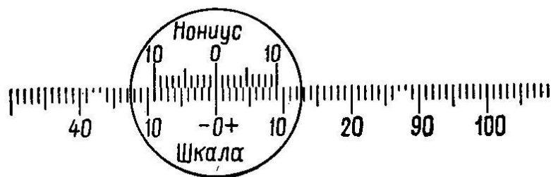
Рис. 1. Співпадання нульових поділок шкали і ноніуса
