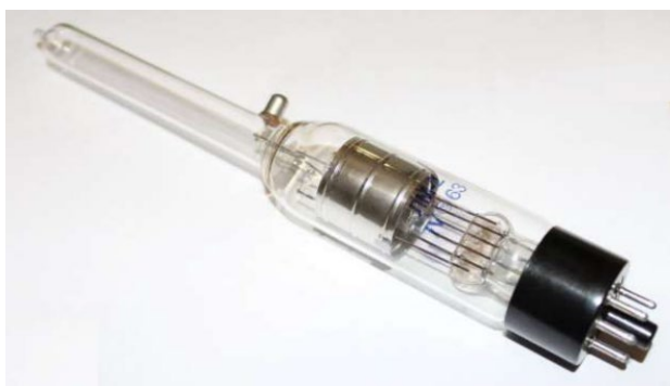
Рис. 11.7. Манометрична лампа ЛМ-2. 1- катод; 2 – сітка; 3 – анод; 4 – молибденові виводи від катода; 5 – молибденові виводи від сітки; 6 – молибденовий контакт від анода; 7 – балон із молибденового скла.
