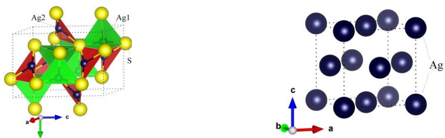
Рис. 2. Проекція атомного впорядкування в структурі аргентум сульфїду ( \alpha - \text{Ag}_2\text{S}_{P2_1/c} ) та срібла ( \text{Ag}_{Fm-3m} ).
