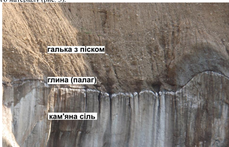
Рис. 3. Нерівність контакту кам'яної солі та підшови палагу (зі збільшенням потужності глинистого прошарку зліва та вклинюванням справа) у центральній частині родовища в межах гірничого відводу шахти № 7
