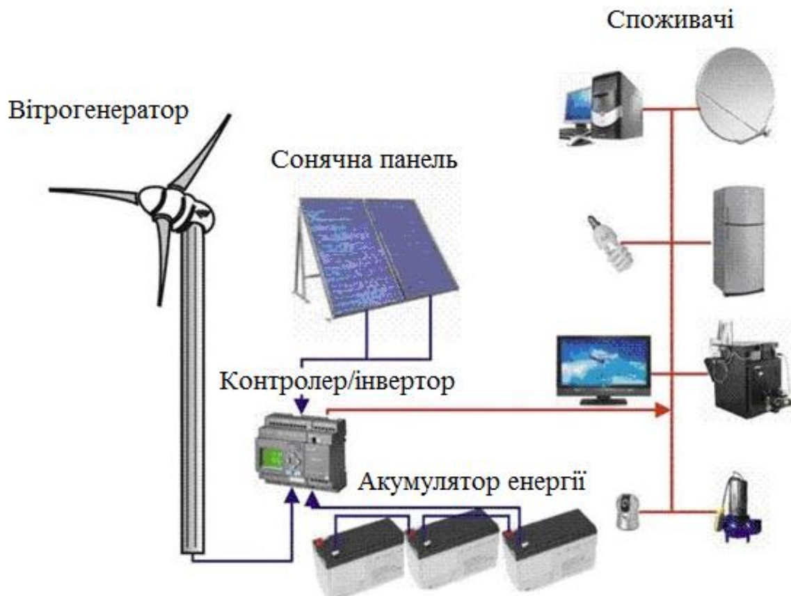
Рис 1 – Схема гібридної вітро-сонячної установки
