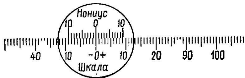
Рис. 1. Співпадання нульових поділок шкали і ноніуса
