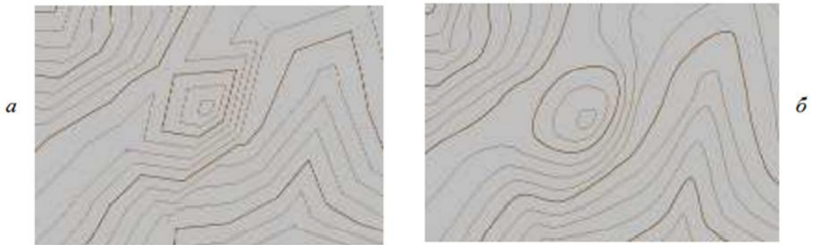
Рисунок 6.11 – Зображення горизонталей: а – побудованих автоматично; б – зглажених
