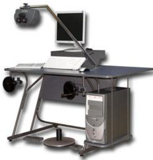
Рисунок 1.1 – Цифрова фотограмметрична станція «Дельта»
