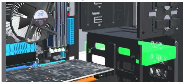
Рис. 1.8. Встановлення внутрішнього(системного) диска
