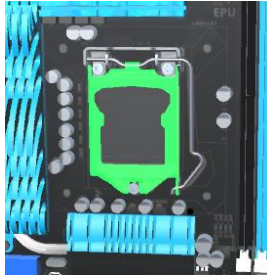
Рис. 1.3. Відкриття сокету для встановлення процесора.
