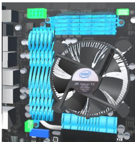
Рис. 1.10. Підключення живлення поцесора та кулерів.
