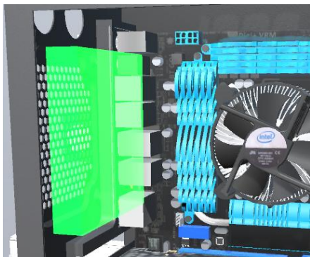
Рис. 1.7 Встановлення додаткового вентилятора на задній панелі корпусу
