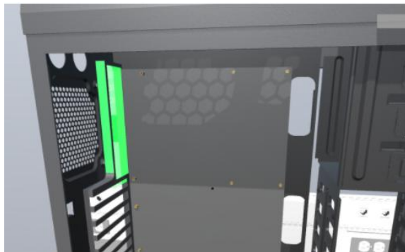
Рис. 1.2. Місце встановлення задньої панелі портів
