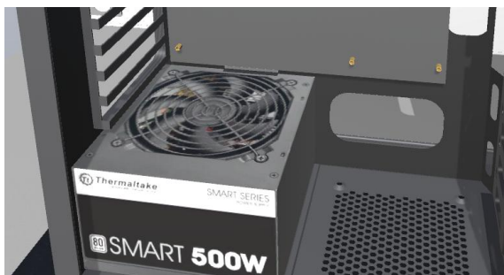
Рис. 1.6. Встановлення блока живлення.
