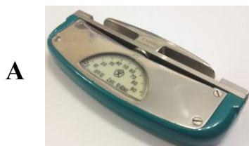
Рис. 1. Пружинні динамометри: А – ручний динамометр ДПР-120; Б – становий динамометр ДС-200.
