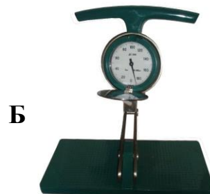
Рис. 1. Пружинні динамометри: А – ручний динамометр ДПР-120; Б – становий динамометр ДС-200.
