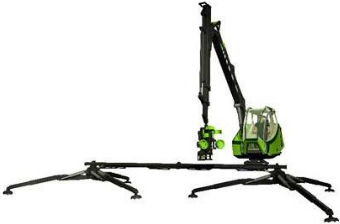
Рис. 13.6. Проект крокуючого харвестера John Deere
