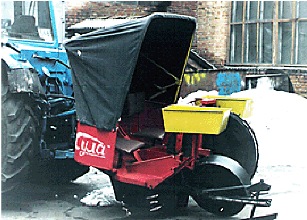
Рис. 8.2. Саджалка для захисного лісорозведення СЗЛ-1 «Сула»
