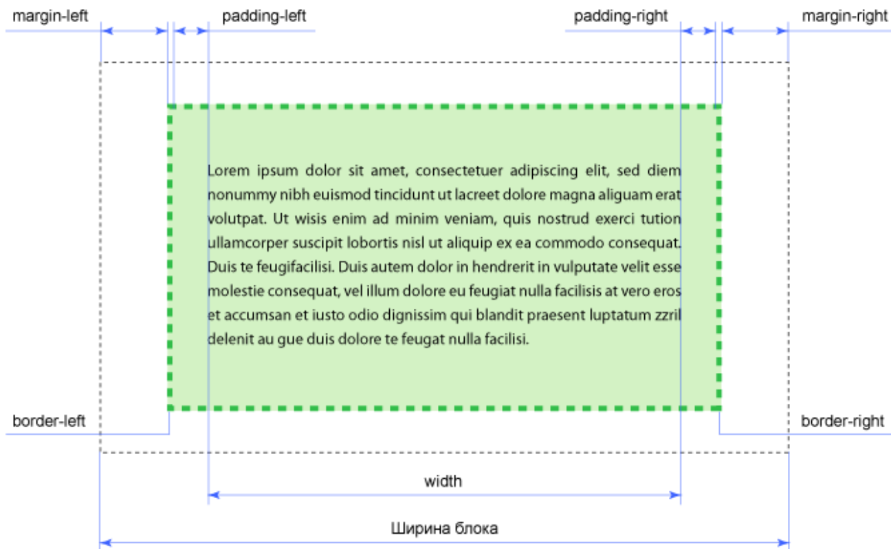
Рисунок 12 – Розмір блочного елемента по горизонталі
