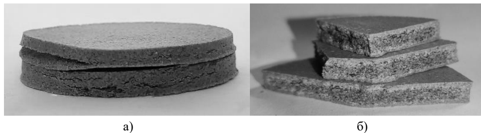
Рисунок 1 – Зразок керамограніту з додаванням 20 % графіту: а) зовнішній вигляд; б) вигляд поперечного зламу
