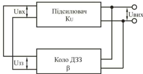
Рис. 11.1.1. Структурна схема генератора синусоїдальних
