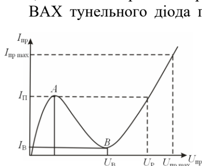
Рис. 5.2.4. Вольт-амперна характеристика тунельного діода
