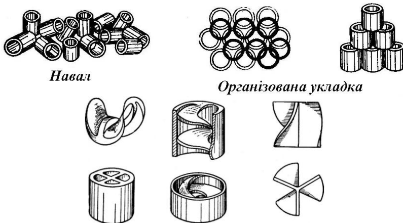
Рис. 55. Насадка “кільця Рашига”.
