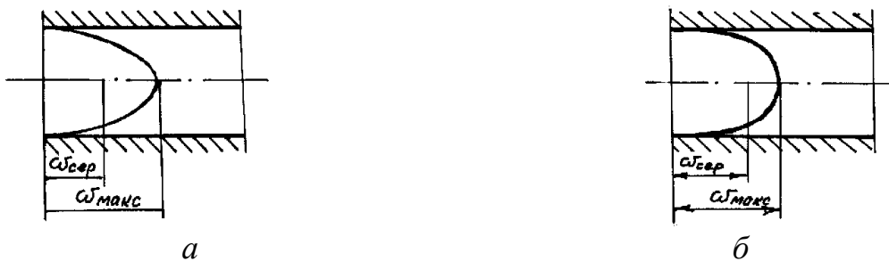
Рис. 5. Епюри розподілу швидкостей при ламінарному і турбулентному русі: а - ламінарний рух; б - турбулентний рух.
