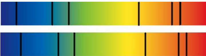
Рис. 3.5 Червоний зсув. Спектральні лінії зміщені у бік довгих хвиль (нижній спектр) по відношенню до лабораторних (верхній спектр). Дане джерело світла рухається від спостерігача.
