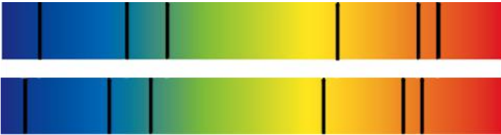
Рис. 3.4 Блакитний зсув. Спектральні лінії зміщені у бік коротких хвиль (нижній спектр) по відношенню до лабораторних (верхній спектр). Дане джерело світла рухається до спостерігача.
