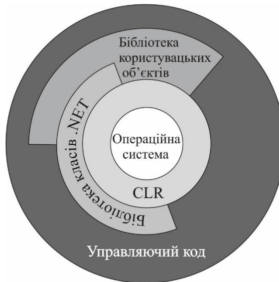
Рис. 11. Зв'язки між управляючим кодом, бібліотеками, CLR та операційною системою
