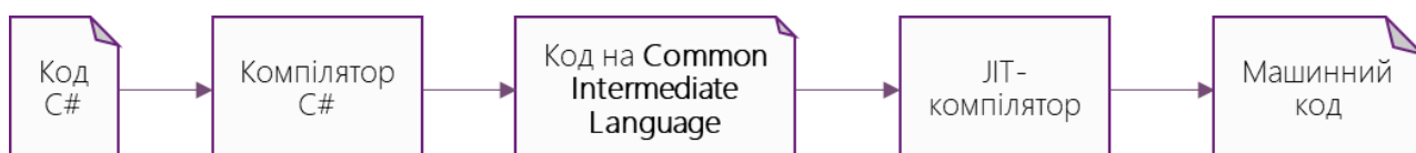
Рис. 8. Етапи процесу перетворення коду мови програмування в машинний код в .NET
